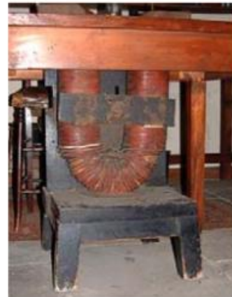
Dispositivo adoperato da Faraday per lo studio del diamagnetismo (Royal Institution, London)
